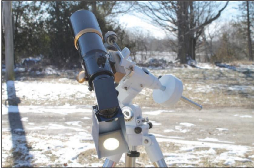
*Okular-Projektion durch einen Refraktor unter Benutzung einer 'Hossfeld-Pyramide'.*
