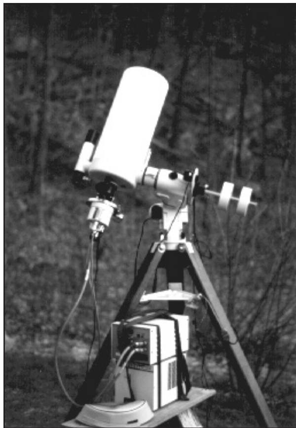
Teleskop Gary Walkera wyposażony w kamerę CCD
