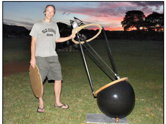
Майк Линнотт (LMK) со своим самодельным 20-дюймовым (f/3.6) ньютоновским рефлексором на сферической монтировке.
