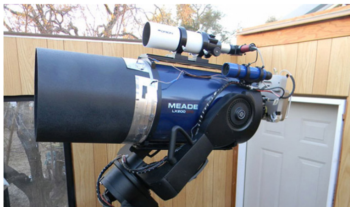
Dwa z teleskopów sieci AAVSONet: BSM-Hamren, 65mm refraktor Astro-Tech AT-65EDQ (po lewej) oraz Coker 30, teleskop Meade LX-200GPS o średnicy 30cm (po prawej)
