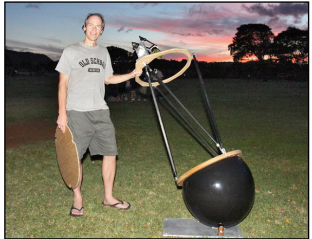
Mike Linnolt (LMT) mit seinem selbstgebauten 20-Inch f/3.6 Newton Spiegelteleskop mit Kugelmontierung.
