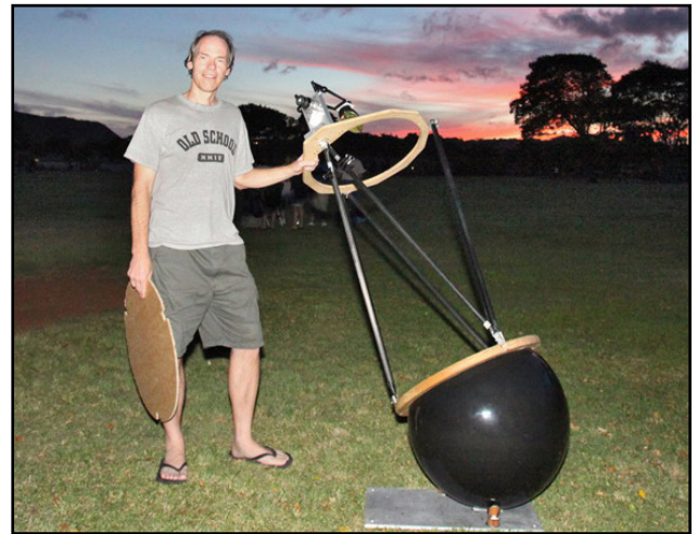
Ο Mike Linnolt (LMK) με το ιδιοκατασκευασμένο νευτώνειο τηλεσκόπιο 20" f/3.6 σε σφαιρική στήριξη.
