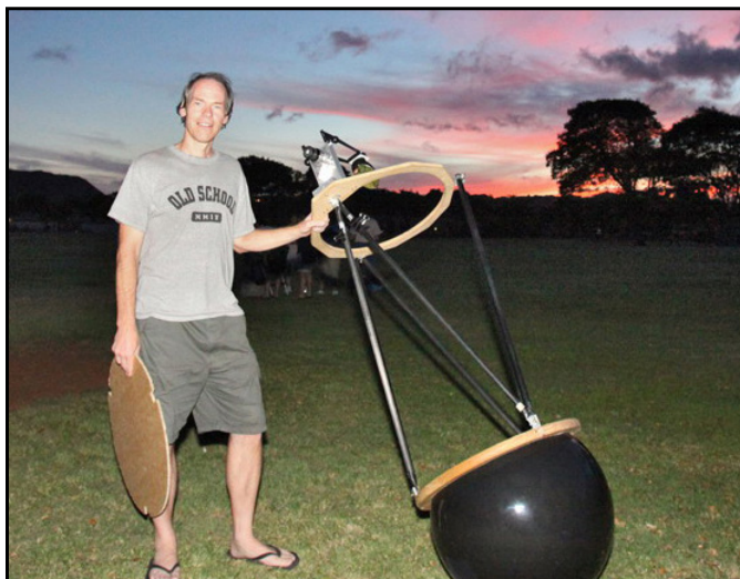
Mike Linnolt (LMK) saját készítésű 50cm-es, f/3,6-os gömb-mechanikával rendelkező Newton-távcsövével
