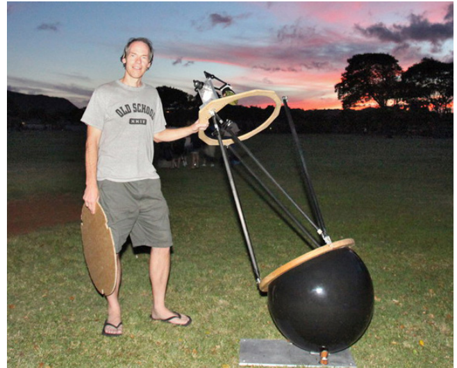
Mike Linnolt (LMK) z własnoręcznie wykonanym 20" teleskopem Newtona f/3.6
