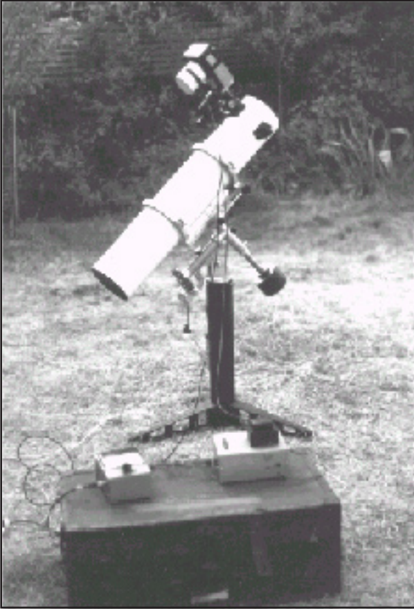
Kevin Krisciunas'ın Fotoelektrik Fotometre takılı 6 inçlik aynalı teleskobu
