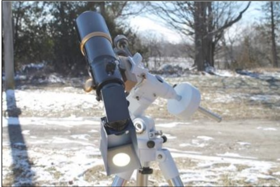
Projeção da ocular por meio de um refrator usando uma pirâmide de Hossfield.
